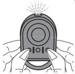
Appuyer simultanément sur les touches extérieures droite et gauche de la télécommande.
