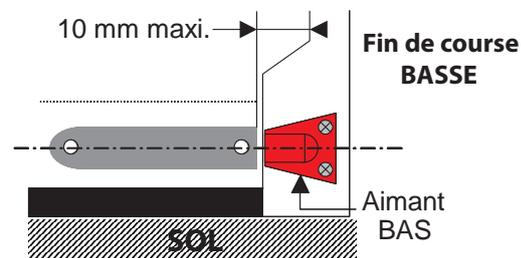
**BAS** : Retirer le film de protection arrière et visser l'aimant sur la coulisse comme indiqué sur la schéma.
