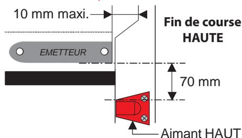
**HAUT** : Retirer le film de protection arrière et visser l'aimant sur la coulisse comme indiqué sur le schéma.
