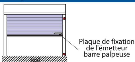
Positionner le tablier à mi hauteur à l'aide d'un câble de réglage filaire (non fourni).
