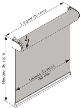
Dimensions/ Dimensions de pose • Largeur: max. 4,00 m (en fonction du tissu) • Hauteur: max. 4.00 m (en fonction du tissu) : max. 12,0 kg (en fonction du moteur)
