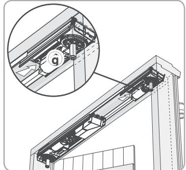
8) Pointer les trous du module mécanique **g** côté moteur.
