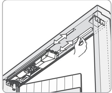
7) Emboîter le module mécanique **g** sur la seconde équerre tout en recouvrant les rails d'alignement.
