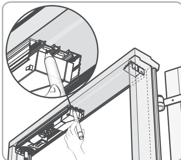
3) Retirer le module électromécanique **d** et percer les trous.
