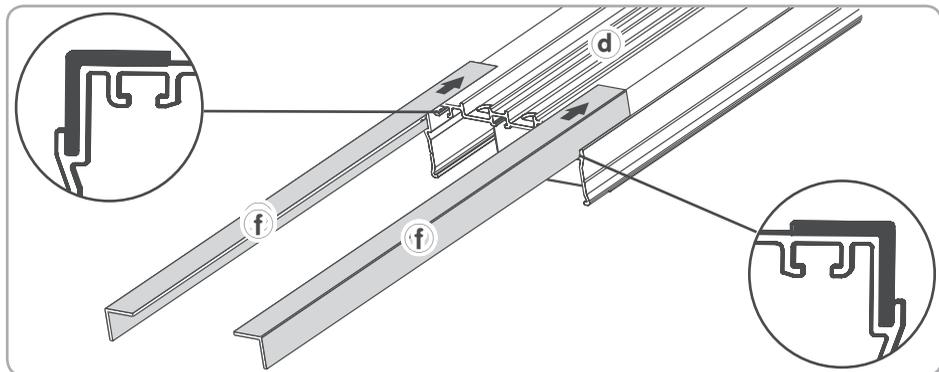
5) Repositionner le module électromécanique **d** sur l'équerre et en face des trous de fixation.
