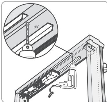
10) Repositionner le module mécanique **g** sur l'équerre en face des trous de fixation. Fixer et serrer les deux modules avec les vis appropriées. (en faisant attention à être le plus parallèle possible au repère tracé).
