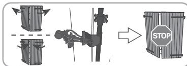
**i** Si le volet battant part d'une position complètement ouverte ou fermée, celui-ci part en mouvement inverse jusqu'à la fermeture ou l'ouverture complète.
