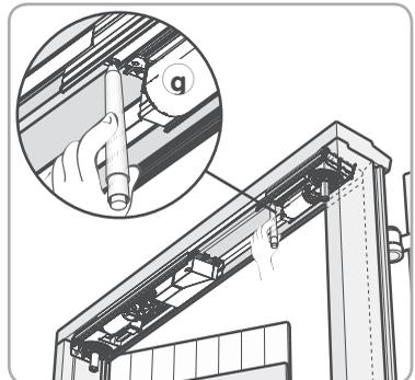
9) Retirer le module mécanique **g** et percer les trous.
