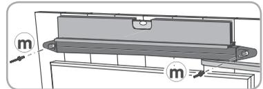
**⚠** **Cas d'installation avec feuillure :** à l'aide d'un niveau, positionner obligatoirement les coulisseaux horizontalement et effleurer le bord extérieur (celui opposé aux gonds) de chaque vantail. Les embouts de coulisseaux
