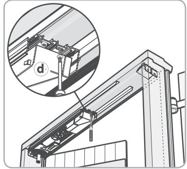
6) Sortir les rails au maximum tout en gardant au minimum 50 mm de rails engagés dans le module électromécanique.
